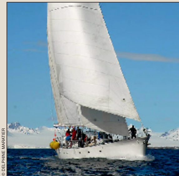
Southern Star est un dériveur lesté en aluminium dessiné par William Tripp. Longueur: 23,70 m - Largeur: 5,60 m Surface de voile: 340,00 m² - Motorisation: GM 165 Ch - Eau douce: 2000 l - Gazole: 2000 l
